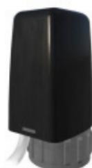
MVP é um atuador eletrotérmico que garante características técnicas em termos de força (170 N) e curso (4 mm) únicas no mercado e que garantem um desempenho de alto nível quando acoplados às válvulas compostas VP (Pressão Diferencial Máxima 3,5 bar). O MVP está equipado com um anel de montagem também em compósito para garantir a ausência de condensação também no servomotor.
